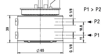
Entlüftungsschrauben bei flüssigen Medien nach oben ausrichten, damit der Entlüftungsvorgang einwandfrei erfolgen kann.
